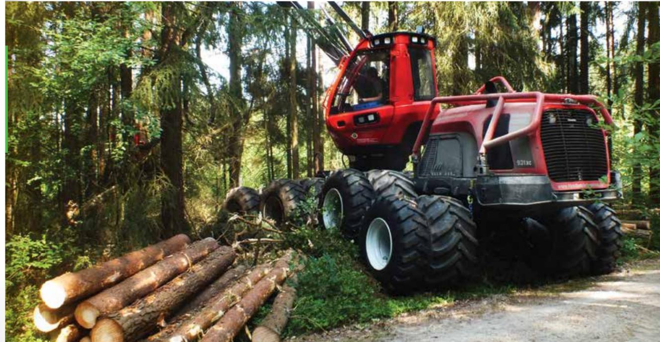
Das B.S.R. Twin Tyre System kann auf allen Forwardern/Rückezügen und Harvestern verwendet werden, egal ob in 4-, 6- oder 8-Rad-Ausführung.
